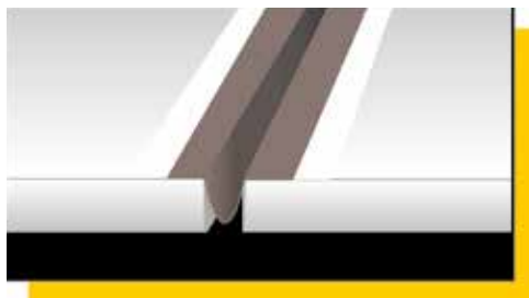
Plaatsing van Mapeband PE 120 in een omegapatroon in een dilatatievoeg
