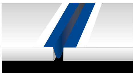
In een omega-vorm Ω aanbrengen van Mapeband in een dilatatievoeg
