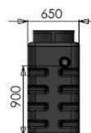
\* Olie-en benzineafscidders of koolwaterstofafscidders worden gebruikt om de derivaten van ruwe olie af te scheiden van het afvalwater.
