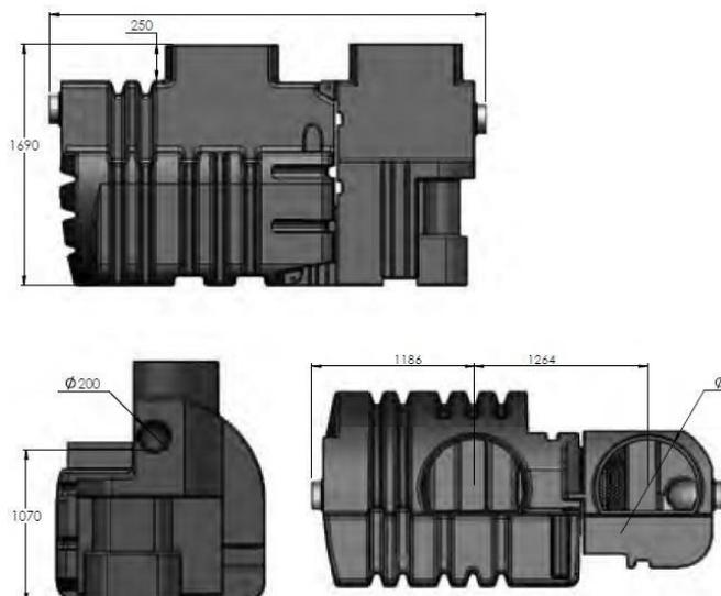
\* Olie-en benzineafscidders of koolwaterstofafscidders worden gebruikt om de derivaten van ruwe olie af te scheiden van het afvalwater.
