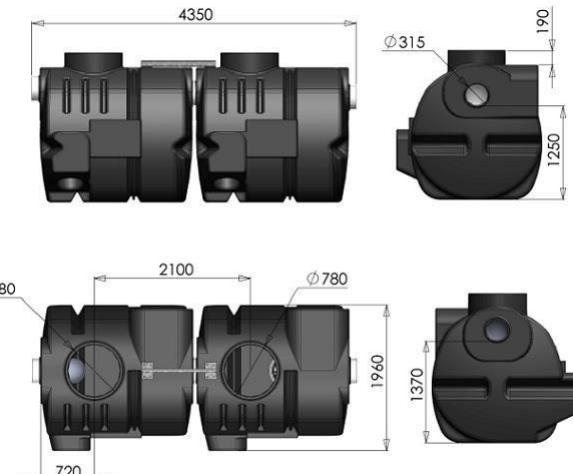
\* Olie-en benzineafscheiders of koolwaterstofafscheiders worden gebruikt om de derivaten van ruwe olie af te scheiden van het afvalwater.
