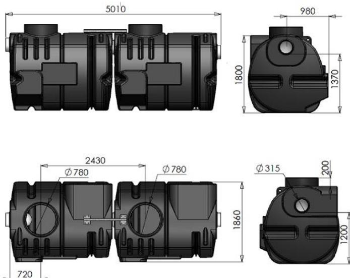
\* Olie-en benzineafscheiders of koolwaterstofafscheiders worden gebruikt om de derivaten van ruwe olie af te scheiden van het afvalwater.
