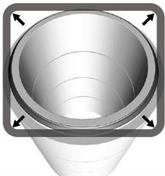
Verdeel de spanning in de dichting door op minimaal 4 punten de ring meerdere malen naar buiten te trekken. Het is essentieel dat de dichting over de gehele omtrek vlak aansluit tegen de spie.
