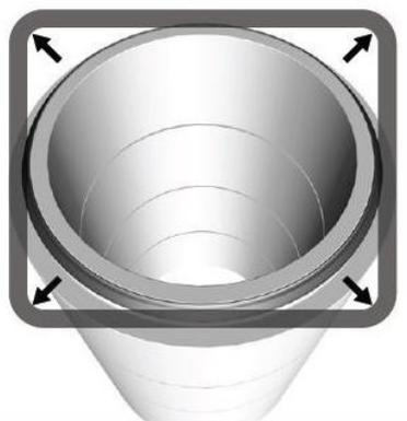
Répartissez la tension sur le joint en tirant l'anneau vers l'extérieur à un minimum de 4 points différents. Il est essentiel que le joint soit en contact avec l'emboîtement sur l'ensemble de sa superficie
