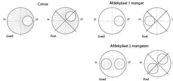
6. **Plaatsing van afdekplaten met een mof- spieverbinding met rubberdichting**, dient te gebeuren conform het plaatsingsvoorschrift Forsheda F116 glijdichtingen. Deze dichting is zelfmerend en garandeert een waterdichte verbinding tussen dekplaat en betonput.
