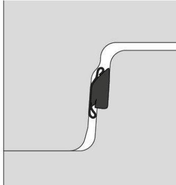
Centreer de afdekplaat/schachtring/conus boven de put en laat deze door zijn eigen gewicht over de spie zakken, totdat de onderkant van de mof volledig opligt. (zie afbeelding)
