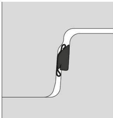
Centrez la plaque de recouvrement/l'anneau de puits/le cône au-dessus de la fosse et abaissez-le/la par son propre poids sur l'emboîtement, jusqu'à ce que le dessous du manchon soit entièrement dessus. (voir illustration)
