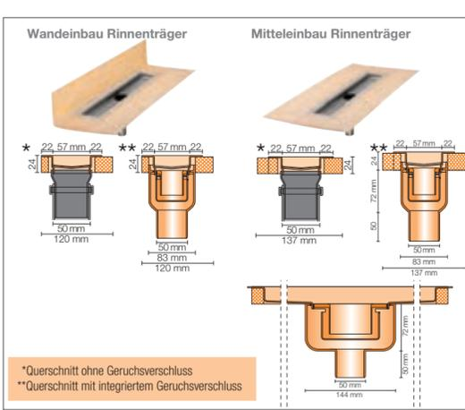
\*Querschnitt ohne Geruchsverschluss
